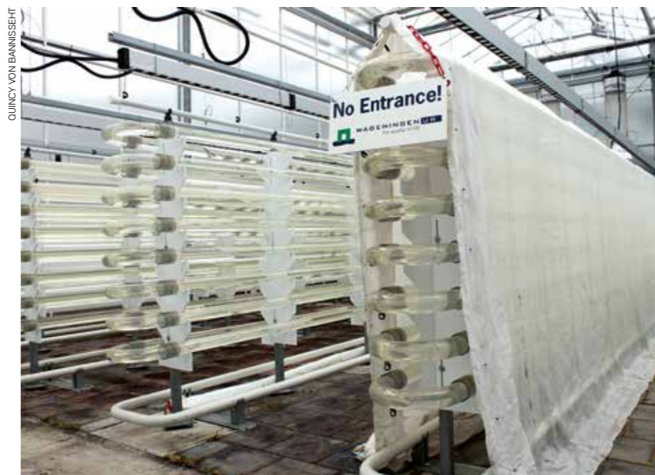
In een gesloten buizensysteem worden bij WUR Glastuinbouw in Bleiswijk hoogwaardige algen geteeld voor de productie van het antioxidant astaxthine.
